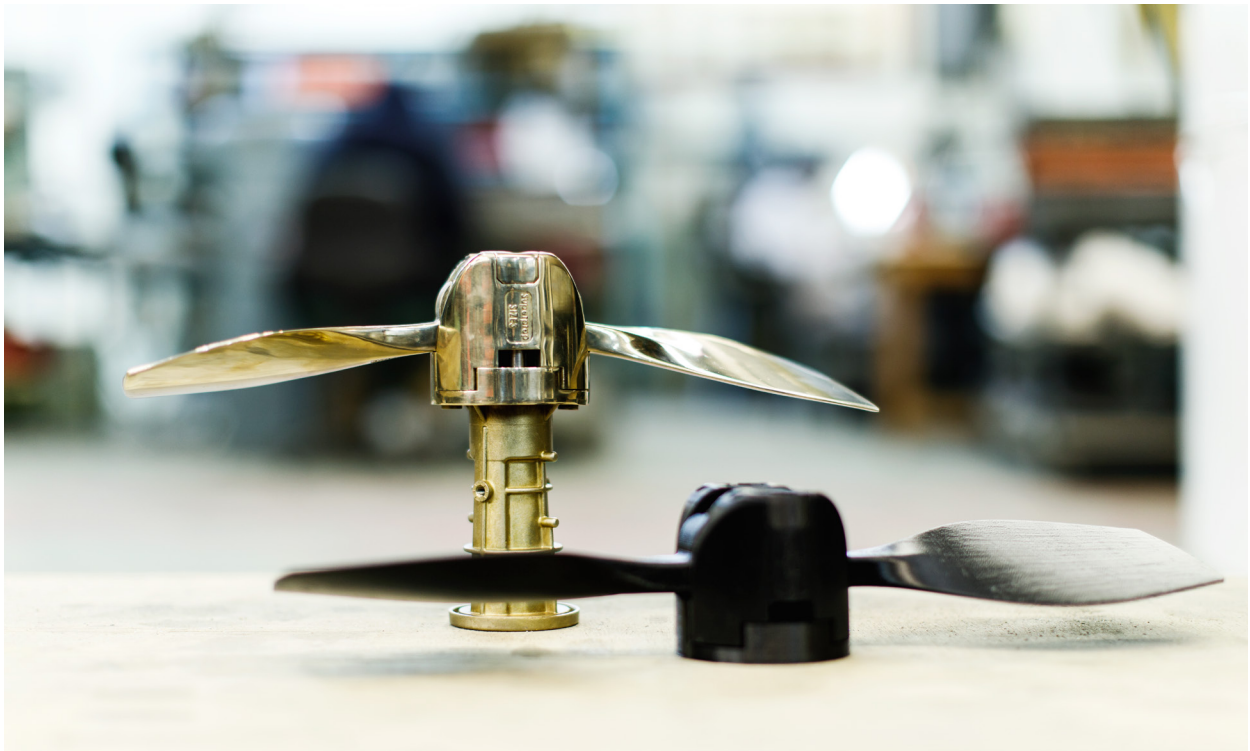
在 Ultimaker 打印机上通过 3D 打印制作的螺旋桨原型(旁边是最终成品版本)
